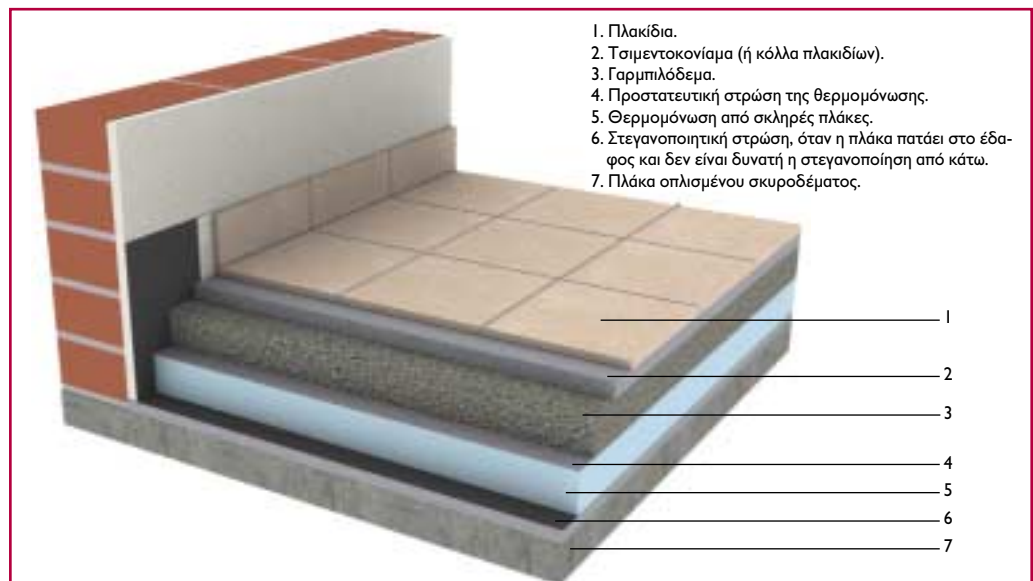
Επίστρωση θερμομονωμένου δαπέδου με κεραμικά πλακίδια.
