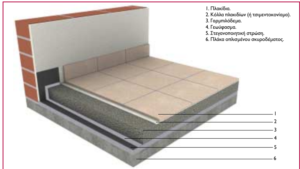
Επίστρωση δαπέδου με κεραμικά πλακίδια και στεγανοποίηση του υπόβαθρου.
