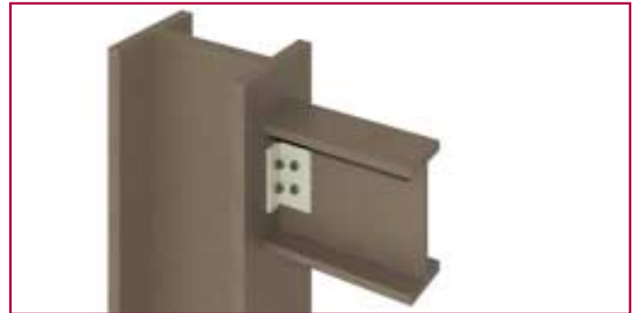
Σύνδεση δοκού - υποστύλματος με κοκλίωση γωνιακού ελάσματος.
