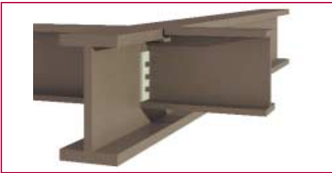
Σύνδεση κύριας και δευτερεύουσας δοκού με κοκλίωση μετωπικής πλάκας επί της κύριας και συγκόλληση της δευτερεύουσας.
