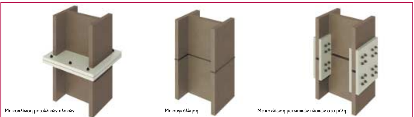
Αποκατάσταση συνέχειας διατομής υποστύλματος.
