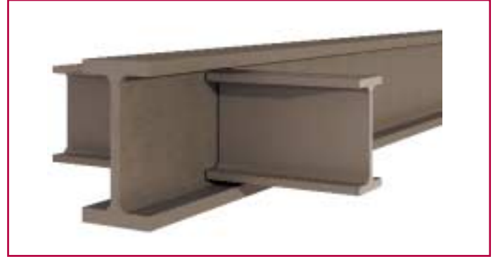
Σύνδεση κύριας και δευτερεύουσας δοκού με συγκόλληση.
