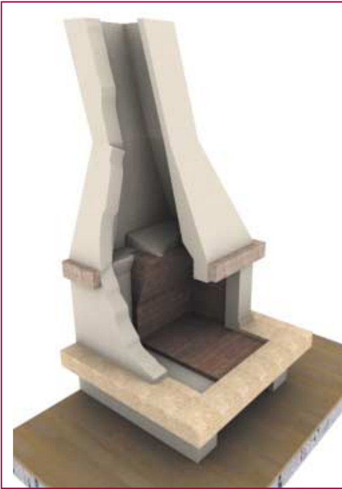
Ενδεικτική κατασκευή τζακιού.
